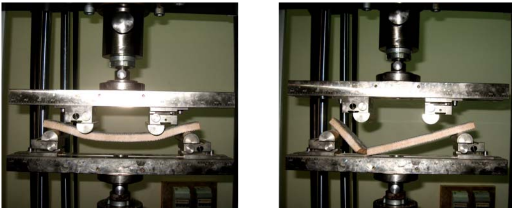
Figure 5 : Essais de flexion quatre points (a) : avant rupture, (b) : après rupture.
