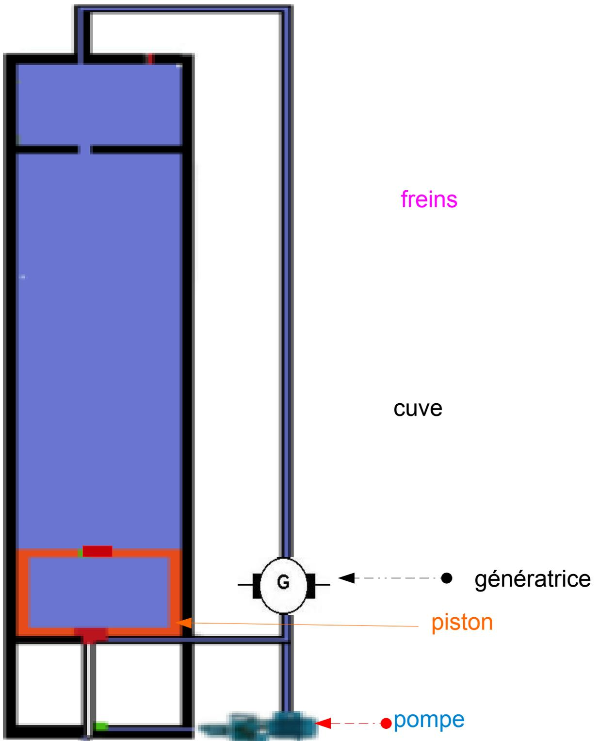
L'électrovanne du bas du piston s'ouvre permettant à l'eau de s'écouler et à l'air de remplir le piston l'électrovanne du haut du piston es fermée
