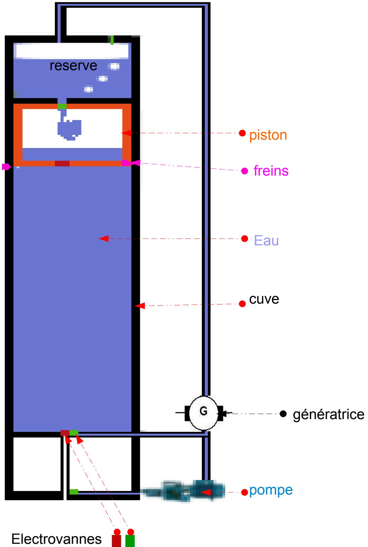
Les freins sont relâchés le piston descend chassant l'eau sous pression qui en remontant dans la cuve fournit de l'énergie grâce à la génératrice
