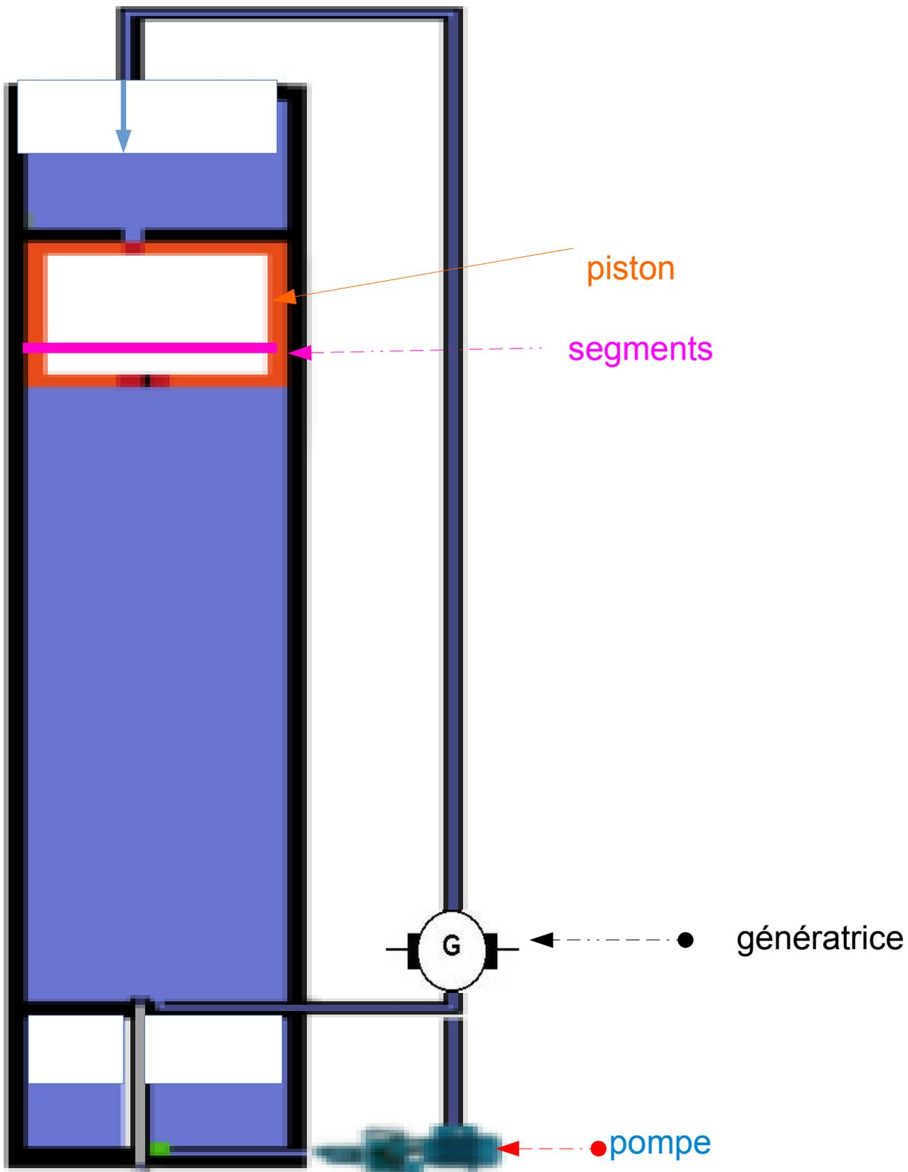
L'électrovanne du piston s'ouvre, le piston se remplit d'eau et chasse l'air qu'il contient des freins le maintiennent en haut
