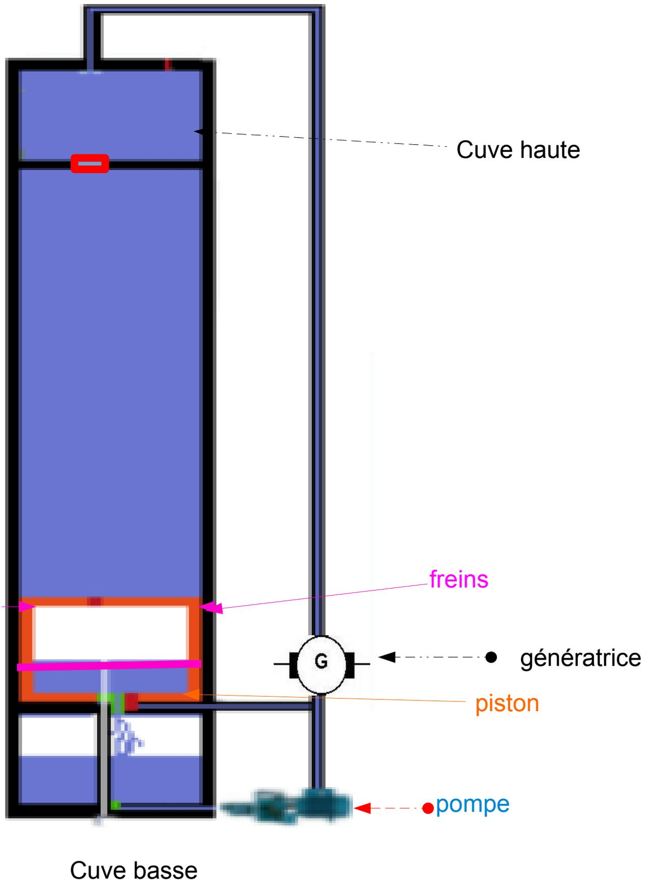
La cuve est vide et remplie d'air elle devient donc plus légère que la colonne d'eau il suffit de relâcher les freins du piston pour qu'il remonte les segments sont rétractés afin de laisser l'eau redescendre
