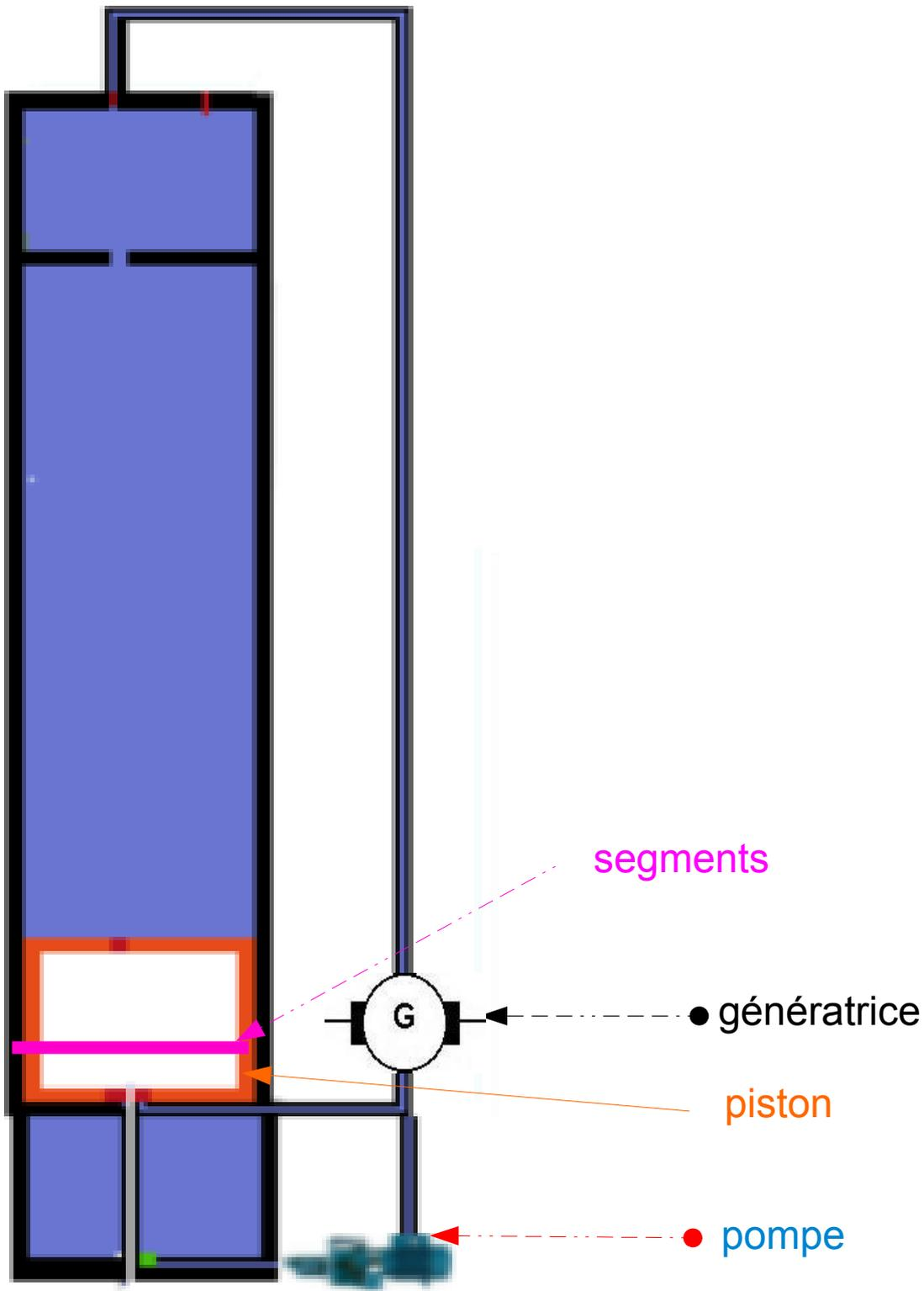
Le piston plus léger remonte l'eau redescend le long du piston dont les segments se sont rétractés la pression intérieure permet de récolter une énergie qui permettra à la pompe de vider la cuve basse
