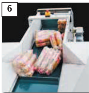
6 Convoyeur : Le convoyeur transfère automatiquement les produits dans la machine
