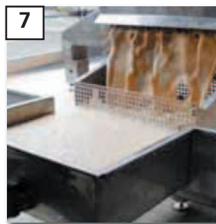
7 Séparateur de liquides : Les liquides sont évacués au travers d'un carter filtrant
