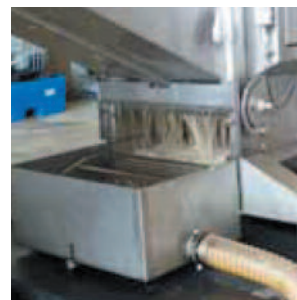
Système de vidage des canettes ou bouteilles
