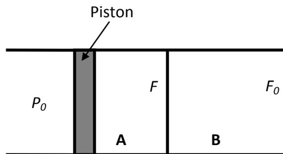
1. Préciser la pression et la température initiales dans le compartiment A. Soit  $\gamma = \frac{c_p}{c_v}$  le rapport, supposé constant, des capacités calorifiques molaires du gaz parfait diatomique, respectivement à pression constante et volume constant. Justifier la valeur de  $\gamma = 1,4$ .
