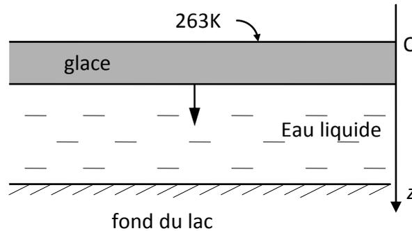
On suppose que la surface supérieure de la plaque de glacé formée (au contact de l'air) est à la température  $T_1 = 263$  K. On suppose que la vitesse de croissance de la plaque gelée est très lente de telle façon que l'on puisse supposer que l'équilibre thermique est atteint dans la plaque.
