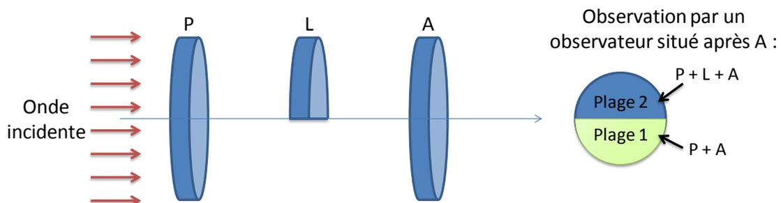
Le dispositif est éclairé par une onde plane monochromatique. Le polariseur (respectivement l'analyseur) transmet une onde polarisée rectilignement, d'intensité  $I_0$  (respectivement  $I$ ), dont le champ électrique est dirigé suivant la direction de transmission du polariseur  $OP$  (respectivement de l'analyseur  $OA$ ). Les lignes neutres de la lame L sont confondues avec les directions  $Ox$  (axe lent) et  $Oy$  (axe rapide). Pour la suite, on notera :
