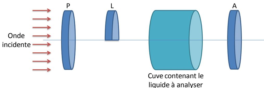
L'objectif de ce système est de mesurer l'angle dont le liquide fait tourner la polarisation (l'angle étant proportionnel à la concentration de la molécule, on peut utiliser ce dispositif pour la doser). On note  $\theta$  l'angle dont fait tourner la polarisation (on supposera  $\theta$  compris entre 0 et  $\pi$ ).
