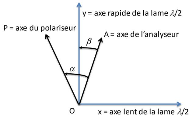
On supposera que les angles  $\alpha$  et  $\beta$  sont différents de 0 et compris entre 0 et  $\pi$ . On négligera l'absorption de P, L et A.
