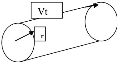
A cette énergie il faut ajouter l'énergie ou le travail des forces de pression  $P$ , qui sont à l'intérieur de ce cylindre. En considérant la force exercée par la pression sur la base du cylindre dans le déplacement  $Vt$ , alors cette énergie =  $P * \pi r^2 * Vt$
