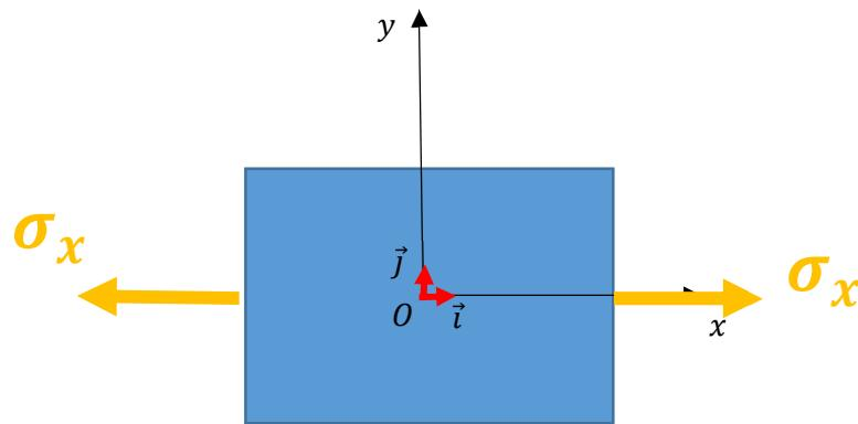
Et si l'une des deux facettes n'étaient pas orienté suivant l'un des axes du plan définit par le repère  $(O, x, y)$ .
