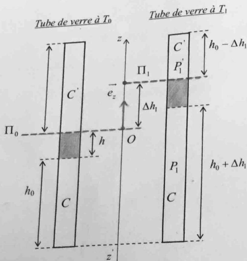
On note  $x_1$  ( $x_1 = \frac{\Delta h_1}{h_0}$ ) le déplacement relatif de la colonne de mercure à la température  $T_1$ .
