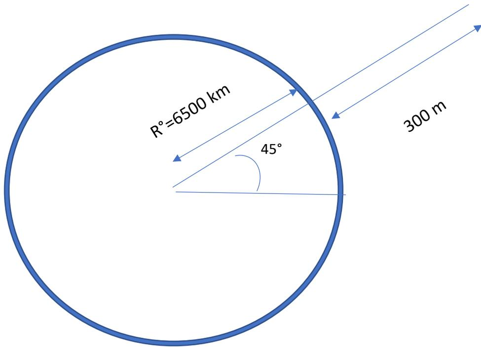
Vitesse sol au pied de la TFL. =  $V_s = 2 \pi R^\circ \cos(45) / (24 \times 3600) = 334 \text{ m/s}$
