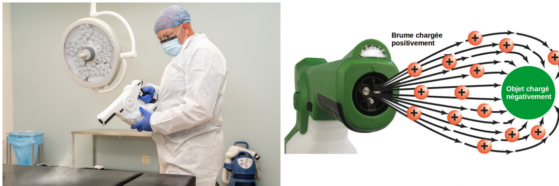
FIGURE 1 – a) Un agent hospitalier applique un désinfectant à l'aide d'un pulvérisateur électrostatique. (b) Principe de fonctionnement du dépôt de particules chargées sur une surface (source Multiclean-system ).
