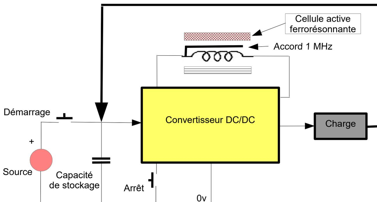
*La cellule active est constituée d'un composite ferromagnétique ayant la particularité de présenter deux fréquences RFM espacées d' 1MHz environ. Cette résultante est mise en évidence par un circuit accordé intégré à l'inductance et fournit de l'énergie magnétique à celle-ci.*
