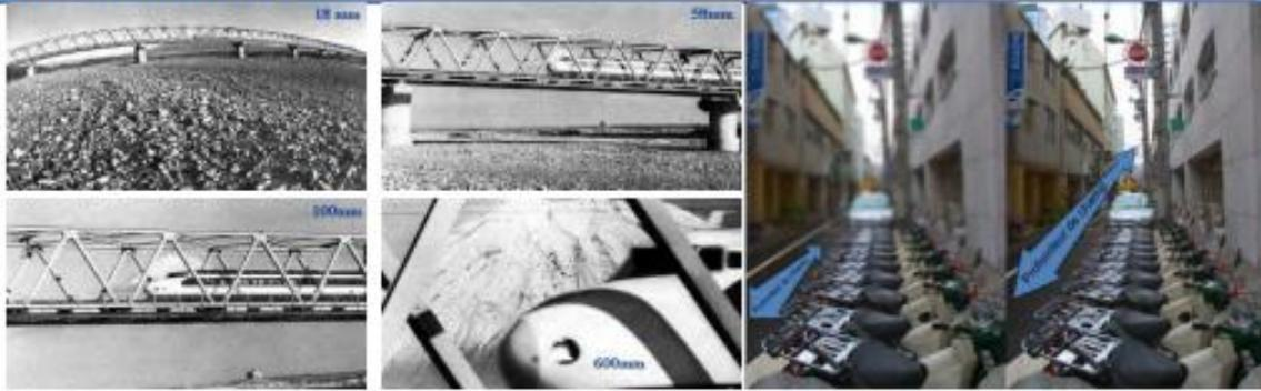
A gauche : images d'une scène acquises avec le même capteur pour différentes valeurs de focales (18 à 600 mm). A droite : profondeur de champ obtenue pour des nombres d'ouvertures différents ( $f/D=3.6$  à gauche,  $f/D=22$  à droite)
