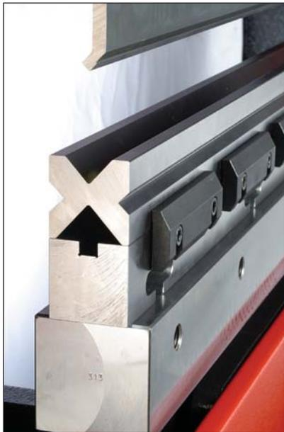
Pour des travaux en épaisseur de 2 à 6 mm, une solution économique consiste à installer une matrice 4 Vés (16, 22, 35, 50) sur une rehausse montée à demeure sur le tablier.
