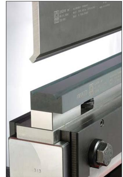
Lorsque les travaux nécessitent un passage entre outils et/ou une hauteur de contre Vé importante (superposition d'inter pour boîte profonde), les porte-règles se montent directement au tablier sans rehausse.
