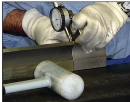
Comme les poinçons, les matrices sont obtenues à partir d'ébauches en acier 42 Cr Mo-4 laminées à chaud et leurs fabrication fait l'objet des mêmes contraintes :
