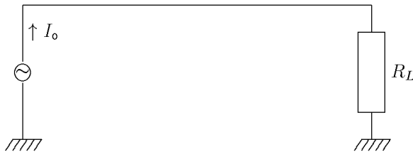
Figure 2.1. La ligne est terminée par son impédance caractéristique.
