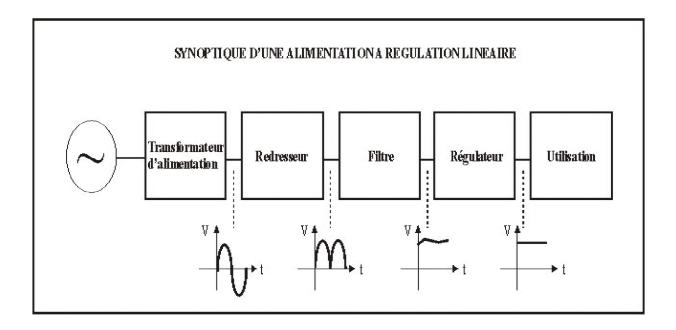
Le redresseur proprement dit permet d'obtenir, en sortie du transformateur d'alimentation, une tension unidirectionnelle pulsée à partir d'une tension alternative sinusoïdale.
