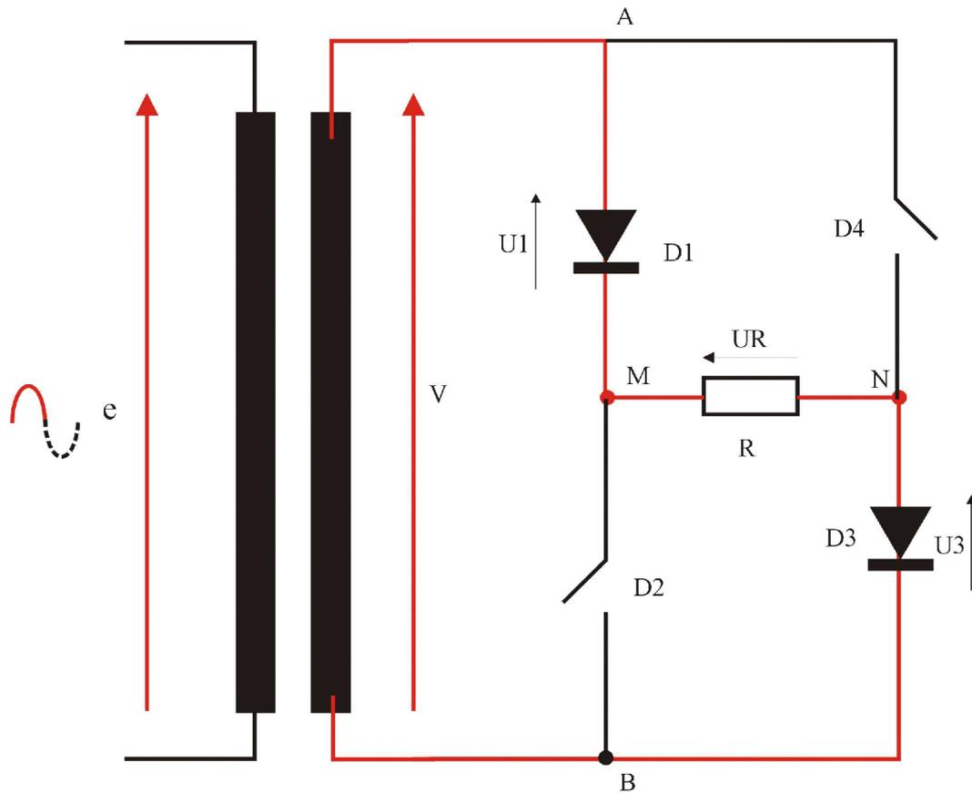
D1 et D3 en série avec R sont polarisées dans le sens passant.
