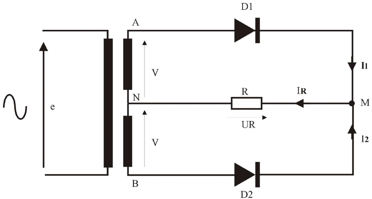
A partir du transformateur à point milieu, on obtient deux différences de potentiels alternatives  $V$  identiques à chaque instant à partir d'une tension unique  $e$ .
