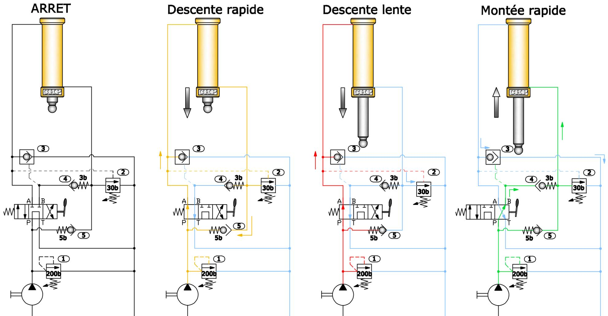
**Exemple de branchement d'un vérin en différentiel charge menante nulle**
