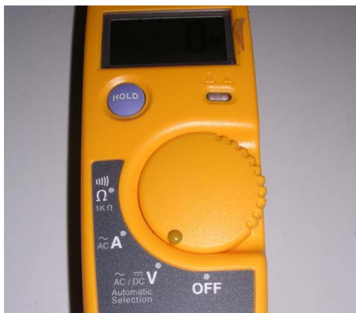
Fig. 30 – Instrument réglé sur l'échelle voltométrique (instrument à sélection automatique AC/DC)
