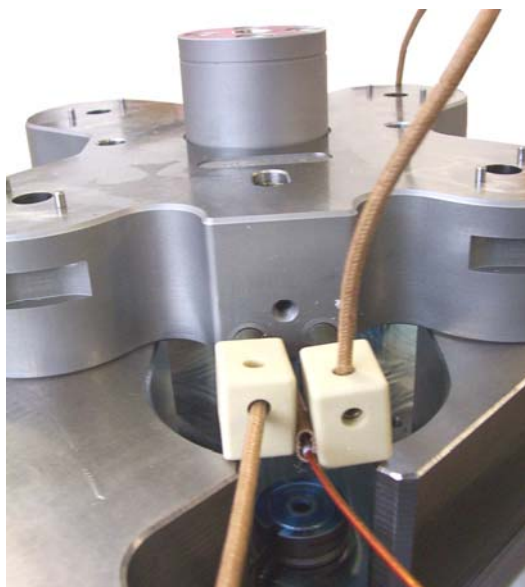
Fig. 23 – Choix d'orientation des connecteurs céramiques
