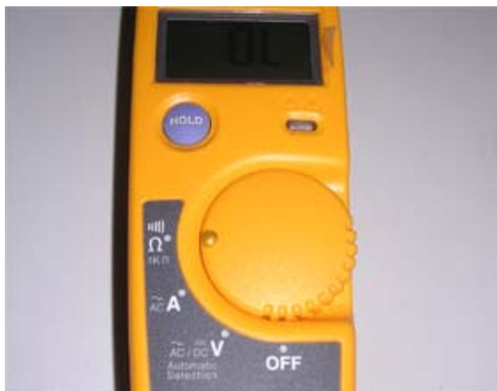
Fig. 29 – Voltmètre réglé sur l'échelle ohmique
