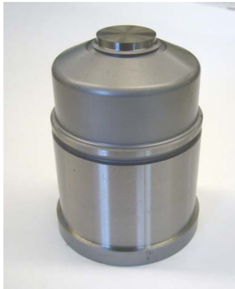
Fig.21 – Douille porte-buse de type « régulées »
