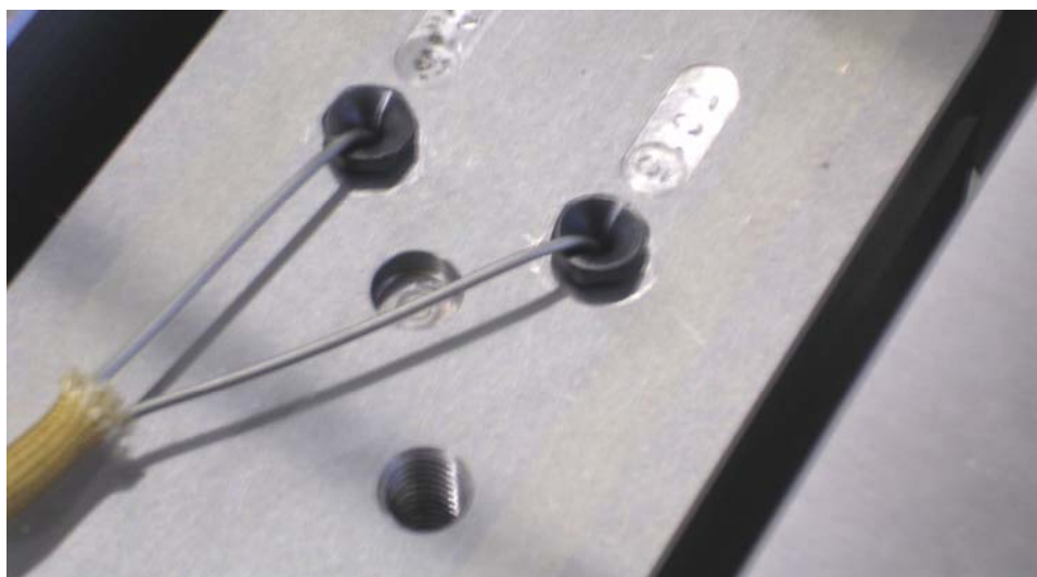
Fig. 26 – Exemple de thermocouples pliés
