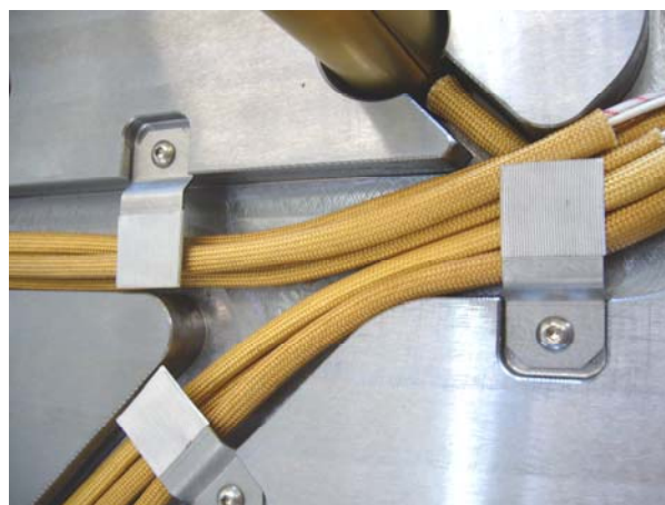
Fig.24 – Exemple de plaquette serre-câble
