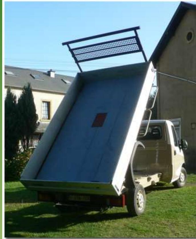
Une trappe de visite dans le plancher de la benne permet de déboulonner la tête de vérin afin de le démonter si besoin était.
