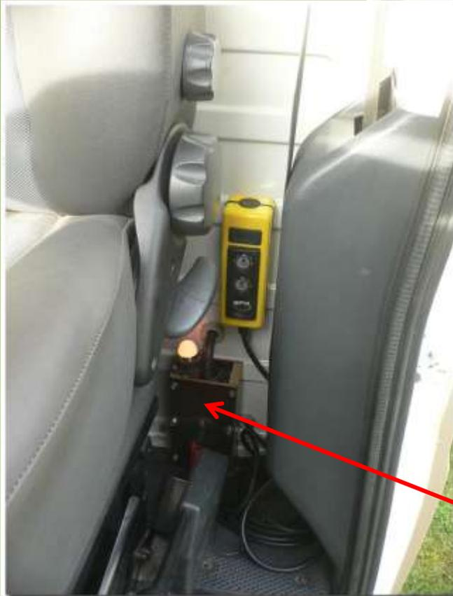
Un coupe-circuit permet de ne pas avoir la tension en permanence sur la pompe.
