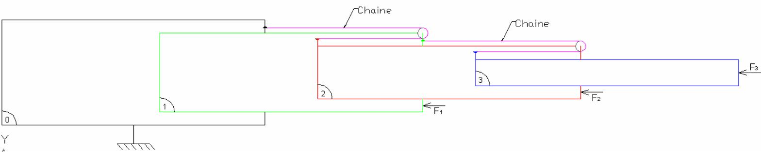
Avec  $F = \text{poids du tube} \times \text{coeff de frottement de roulement des billes}$  (soit 3%)
