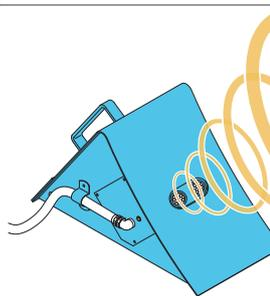
La cale à roue dispose d'un détecteur électronique pour repérer la présence et la position du véhicule. Elle est également reliée au panneau de commande du niveleur de quai. Si aucun véhicule n'est détecté, la station d'amarrage est bloquée pour des raisons de sécurité. De plus, la cale à roue empêche le véhicule de bouger pendant le chargement/déchargement.
