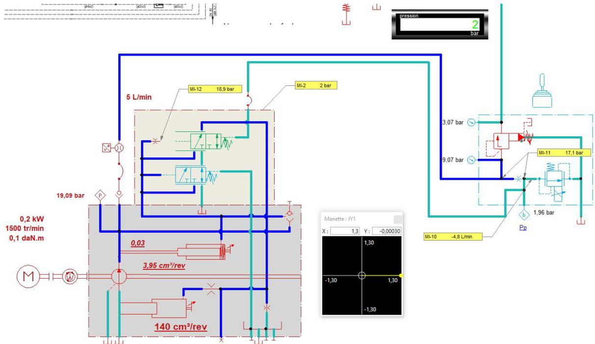
Lorsque le limiteur de pression à commande proportionnelle est alimenté la pression dans le canal « LS » qui communique dans la boîte à ressort de la balance de pression chute à **2bar** ce qui a pour effet d'établir le tarage de la balance de pression à  $2b + \text{celle du ressort}$  (17b). La pression de refoulement de la pompe sera de **19bar**, provoquant le basculement du plateau et ramène la cylindrée de la pompe pratiquement à Zéro.
