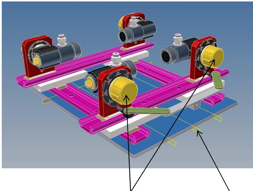
Déplacement Symétrique d'un delta de 60mm des 2 supports (montés sur rail) par rapport à l'axe de symétrie
