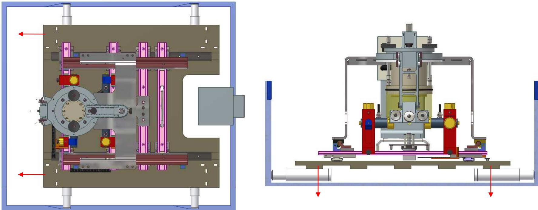
Evidemment avec chanfrein au niveau des flancs de la cuve pour guidage des poussoir
