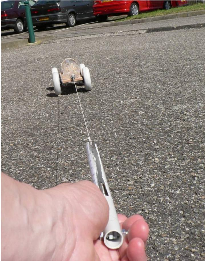
Avec un dynamomètre
